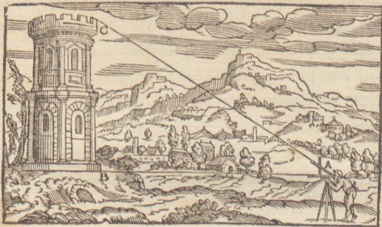
¶ mesutet avec le Trigometre la hauteur d'vn tour ou edifice basty au dessus d'vn Haut montaigne, et semblablement la hauteur de ladite montaigne.
