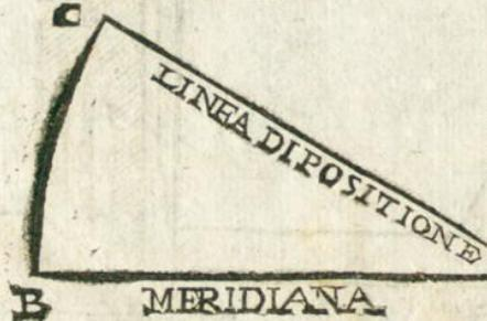
ne, veggiamo il palazzo de Pitti discostarsi dalla linea di mezo dì, verso ponente gradi 24. & chiamasi C: dico che la linea AC, si chiama linea di positione, & di ueduta, & l'angolo ABC angolo di positione, & questo
