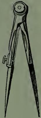
**THE STEEL SPRING SPACING DIVIDERS.**
